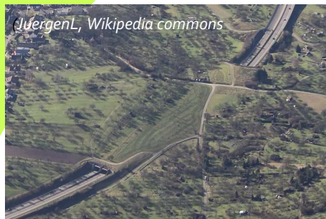
B29 Schlöndorff (Stuttgart) : cet éco-duc ne défragmente pas les petites voies mais limite fortement l'impact de la grande autoroute .
